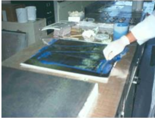
c) Colocación de resina saturante sobre las fibras
