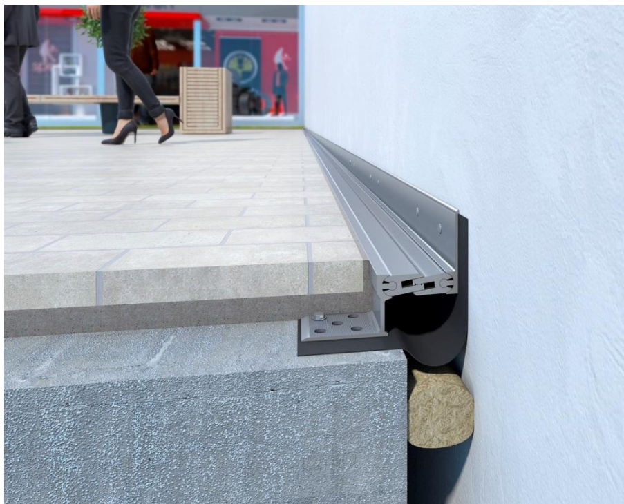
Figura 4. Detalle esquemático de una junta con tope de neopreno entre edificios con separaciones menores que las requeridas. Fuente: www.emac.es/
